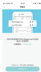
7 此时请长按除湿机控制面板上的WIFI键3秒，以进行机器端与手机端的配网动作，配网过程中WIFI灯处于闪烁状态，如下图：
